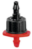
CETA ® PC 1/2 gph Inlet 0.16" with 0.12" or 0.16" Outlet
